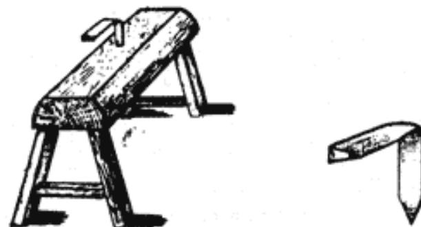
Рис. 15. Скамья для раскалывания обручного кола
