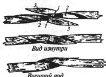
Рис. 41. Замок деревянного обруча:
