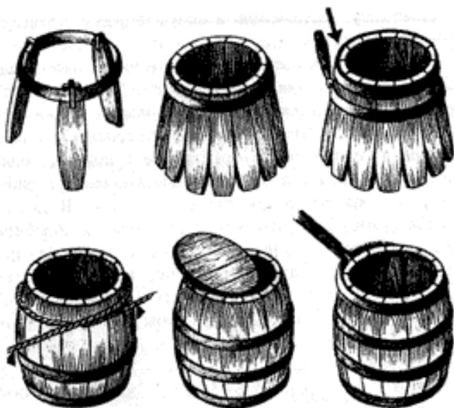
Рис. 62. Сборка посуды с параболическим оставом
