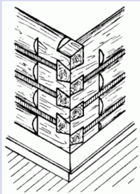
Рис. 61. Схема крепления сруба в лапу.
