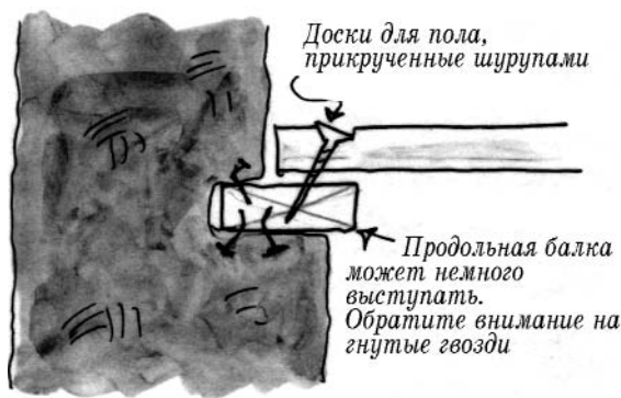
Продольная балка для поддержки перекрытия чердака.
