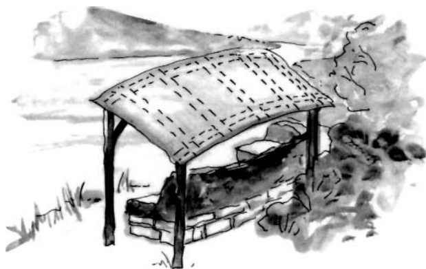
Садовой скамейке, сделанной из самана, понадобится защита от непогоды, иначе она постепенно разрушится от дождя.
