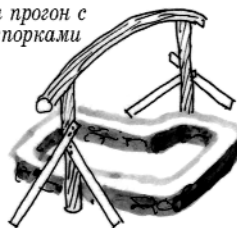
Изогнутый коньковый прогон поддерживает стропила из круглого леса, создавая сложную скульптурную крышу саманного дома в Орегоне.
