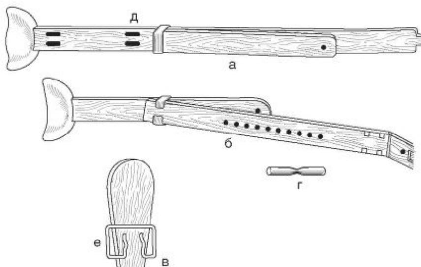
**Рис. 33.** Шина транспортная для нижней конечности (Дитерихса): а - наружная боковая раздвижная банша; б - внутренняя боковая раздвижная банша; в - фанерная подошва с проволочной рамкой; г - палочка-закрутка с выточкой; д - парные прорези в верхних деревянных планках боковых банш; е - прямоугольные ушки проволочной рамки подошвы
