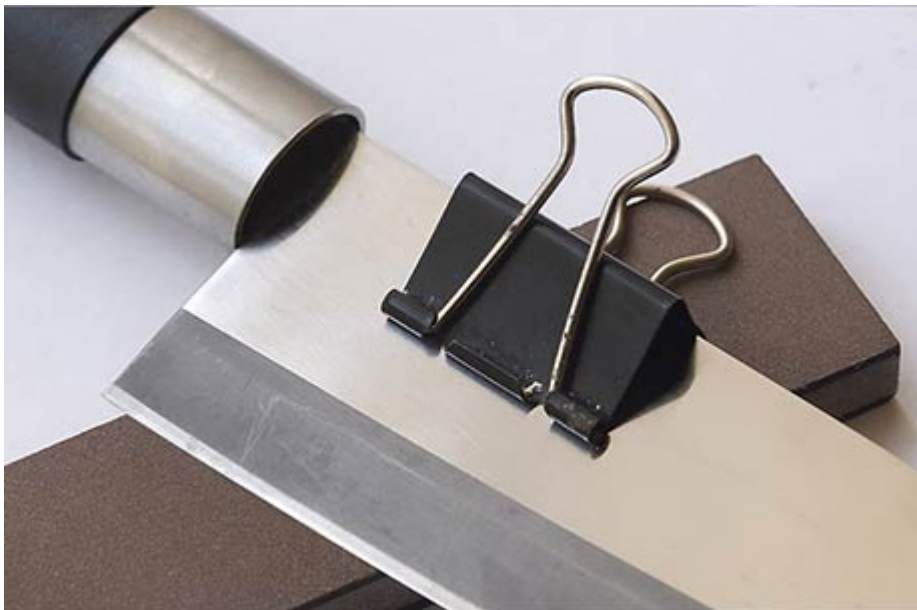
Простейший «прибор» для выдерживания нужного угла заточки
