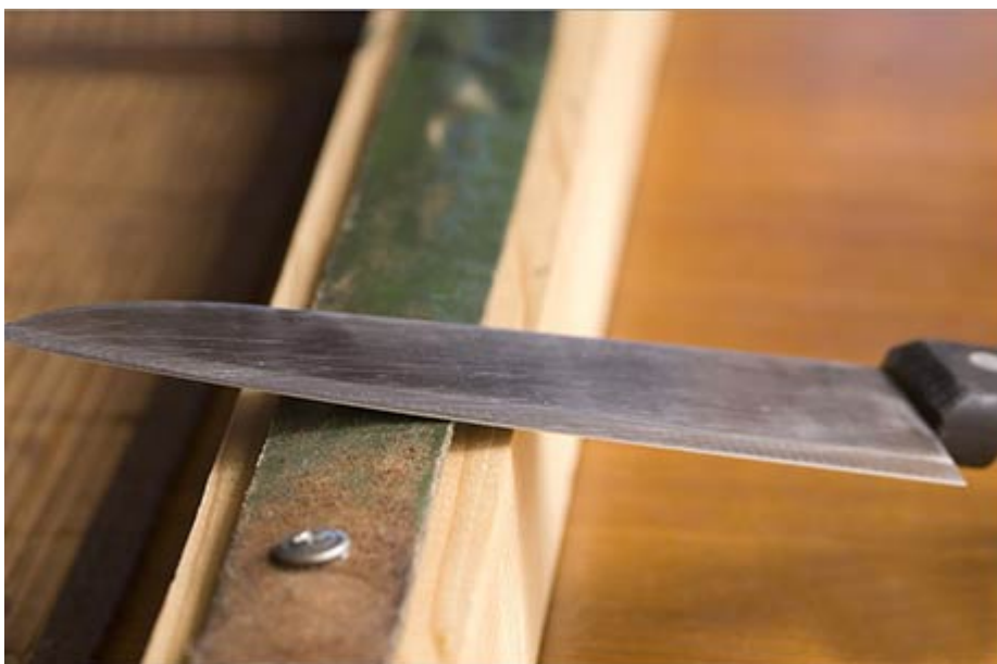
Простейший «прибор» для правки ножей на коже. Закрепляется струбциной на столешнице
